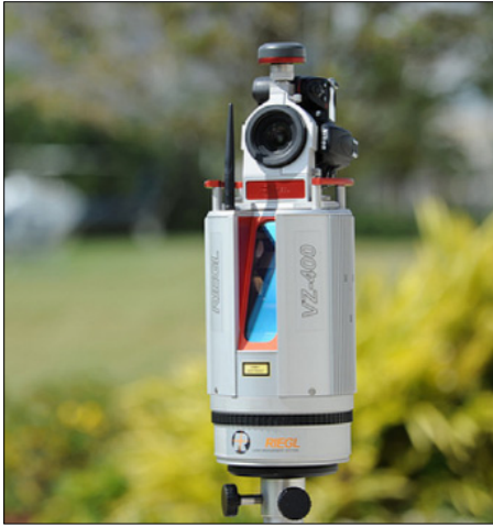
4. ábra A Társaság által használt Riegl VZ-400 statikus lézerszkennő
