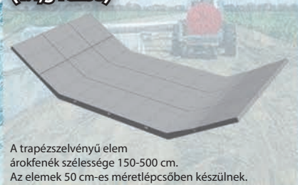
Nagy trapézszelvényű mederburkoló elemcsalád (1:1,5 rézsű)
