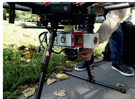
A Ruide cég drónra szerelhető LiDAR szenzora, amelyet élesben tesztelhettünk
