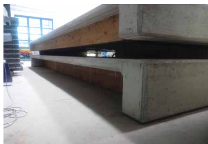
4. ábra: Fa-beton hídmodellek
