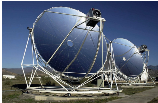
11. ábra. Naptányér Stirling-motorral [1]
