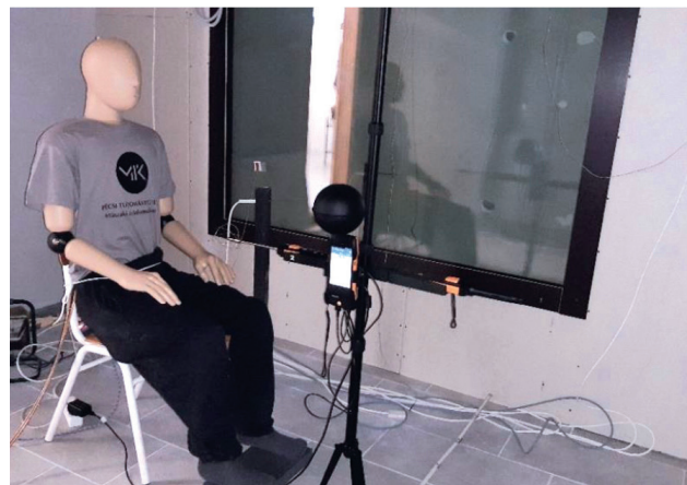
4. ábra. A termikus műember és a TESTO 400 műszer elhelyezése a fűtő üvegfelület előtt 4
