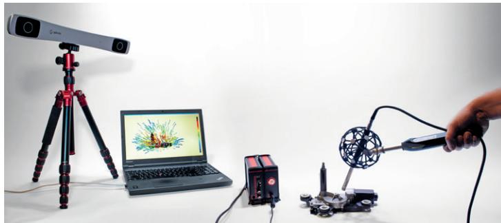
10. ábra: 3D hanglokalizáló rendszer (Forrás: Microflow Technologies)
