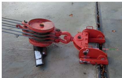
A csiga, a csigarögzőtő és a sín már alkalmazásban, terhelés alatt
