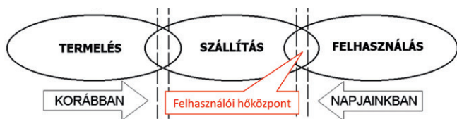
1. ábra A távhőrendszerek alrendszerei
