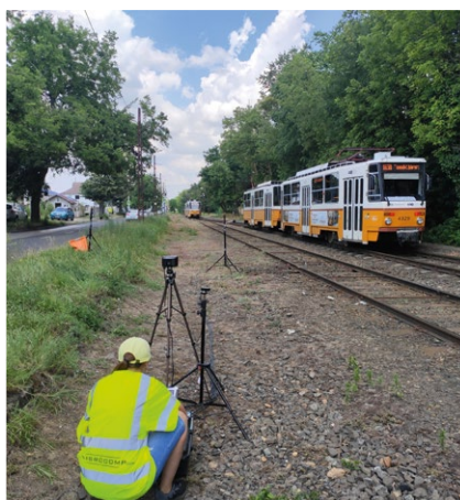
Szimultán zaj-rezgés mérés sebességméréssel, zajmérés a sínszállhoz közel, illetve 7,5 m távolságban, statikus mérés
