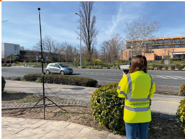
Elhaladási zajszint mérése sebességméréssel
