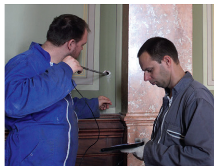
4. kép A díszterem falazatának vizsgálata - kamerás furatvizsgálat, magminták és a vegyes téglafalazat
