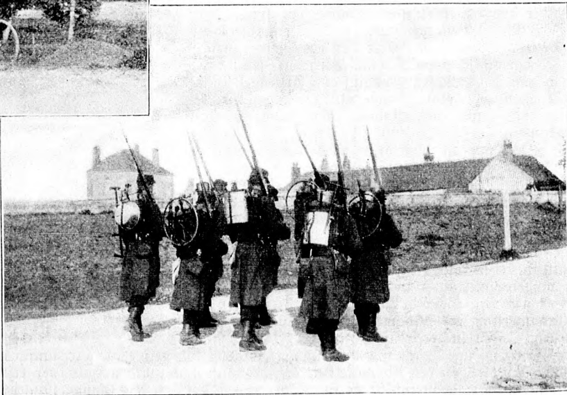
Die einzelnen Teile des Fahrrades auf die Tornister geschlafft. Ein zerlegbares Fahrrad für den Transport von Tornistern. (S. 4)
