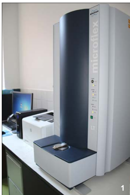
1. fénykép. A bakteriológiai és mikológiai diagnosztika „igáslovát” jelentő, korszerű MALDI Biotyper (Bruker) nagy áteresztőképességű, mikrobiológiai célú tömegspektrométer az intézetben.
