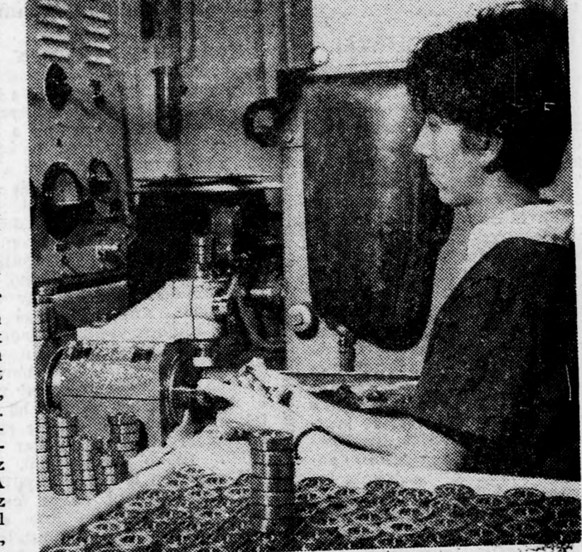
Automata gépsoron készülnek a 6203 TN-típusú csap- ágyak. A mérő vizsgáló gépen méri a minőséget. A gép is mutatja, igazolja a gyártmány jó minőségét. Exportképes a 6203 TN-típusú csapágy
