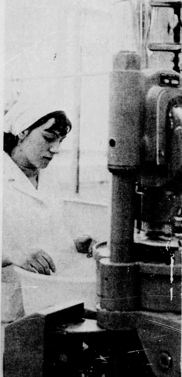
A porrá alakult hatóanyagot nagynyomású tablettázó gépeken préselik össze
