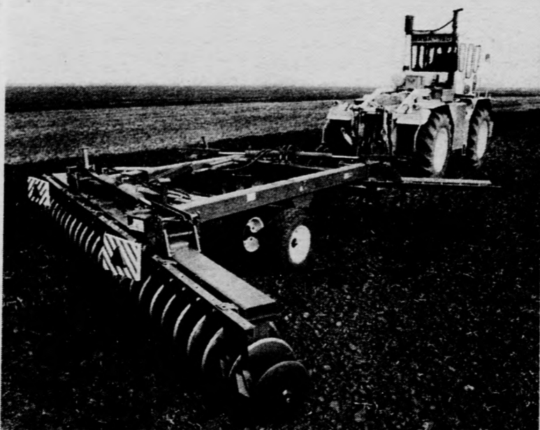
Rába-IH-10-770.07 nehéztárcás borona, amelynek munkaszélessége 6,2 méter és óránként 3–4 hektárt tud megművelni
