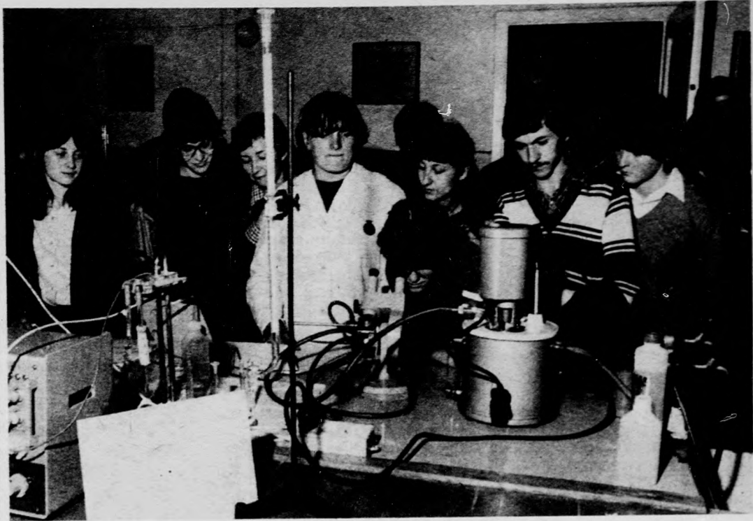
A negyedik osztályos laboratóriumban az Abbe-féle refraktométerrel törésmutatót mérnek (Fotó: Berki István)
