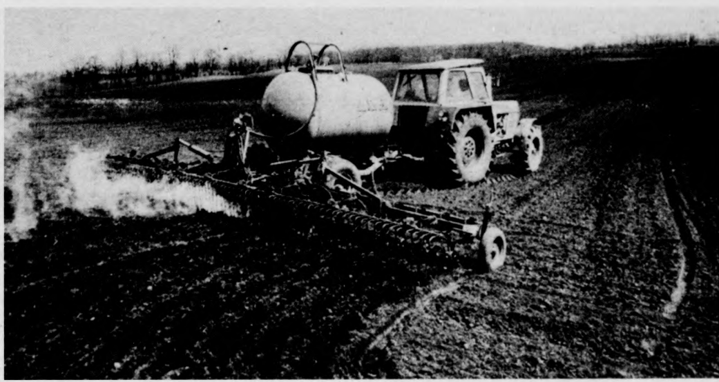
A hajdúdorogi Bocskai Tsz számottevő költséget takarít meg az ammóniát injektáló munkagéppel
