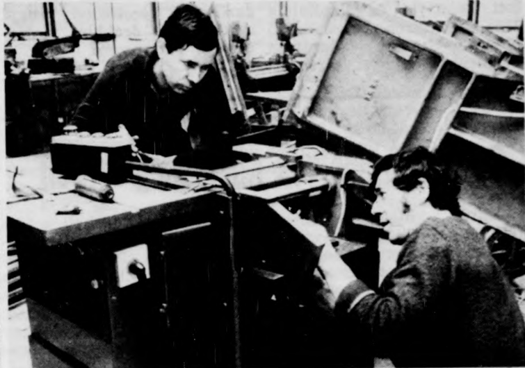
Szerelik a hat művelet elvégzésére képes kombinált faipari gyalugépet
