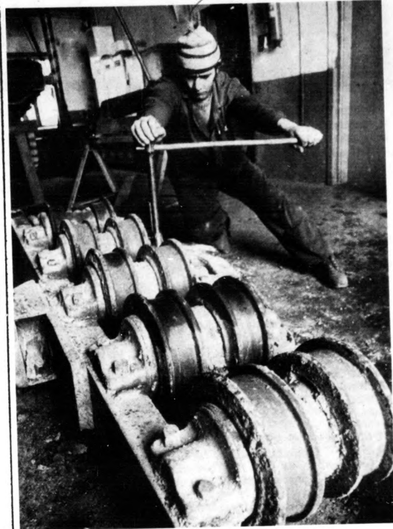
A T-100-as lánctalpas erőgép járószerkezetének javítása a műhelyben
