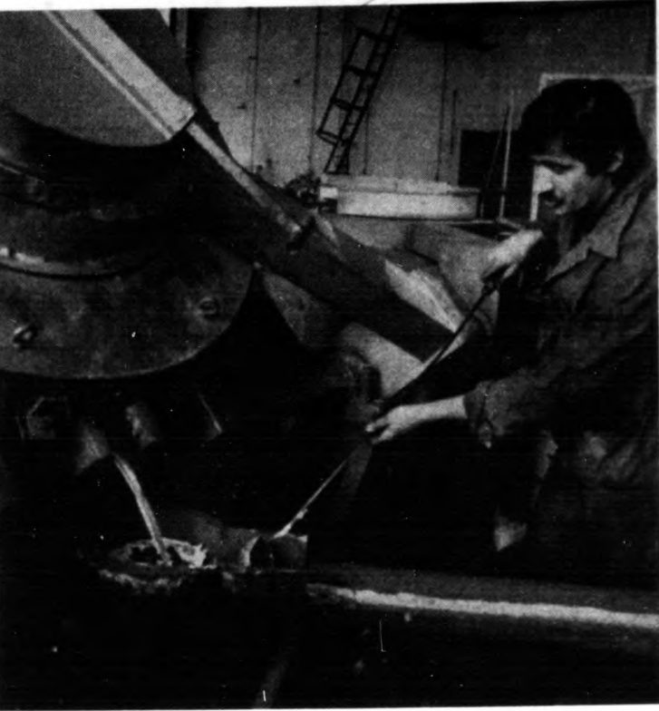
A Junker gyártmányú indukciós és hőntartó kemencéből csapolják a fémötvözetet
