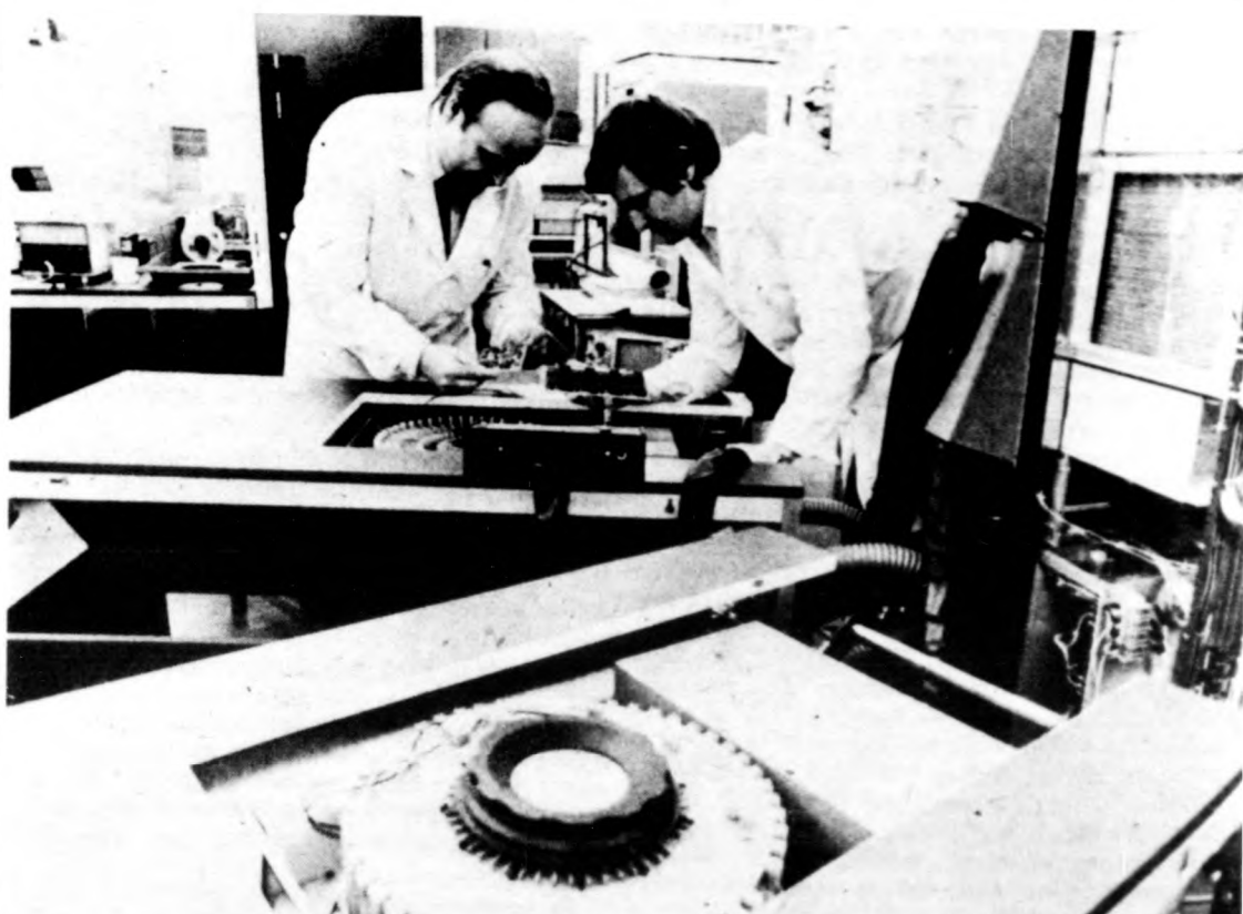
A Mikroelektronikai Vállalat szovjet megrendelésre három mérőautomatát készít. A készülékek másodpercenként (izmíllió mérést képesek elvégezni digitális áramkörökön (MTI-fotó: Balaton József)
