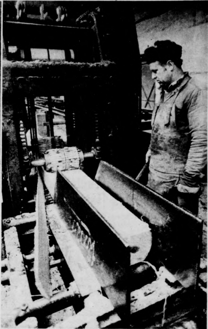
Fűrészelik a 8 méteres fenyőgerendát. Az osztrák keretfűrész egy perc alatt négy métert halad a fában
