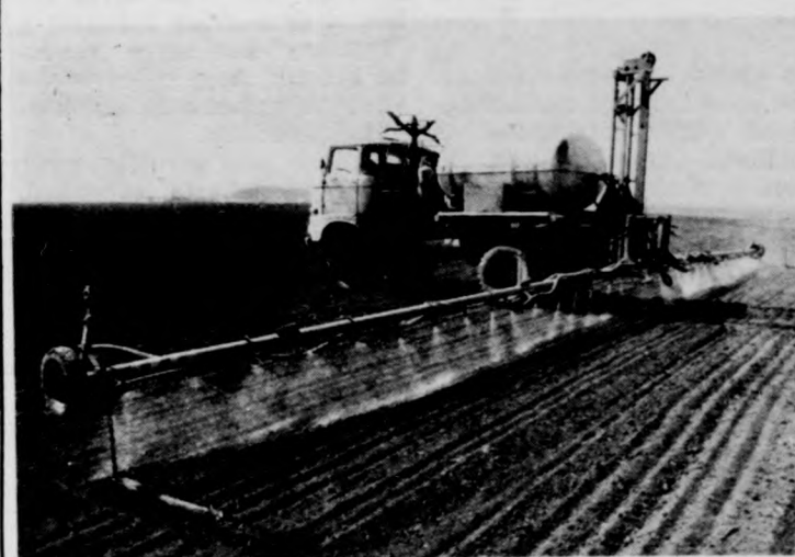
Nagy segítségére van a Dózsa Tsz-nek a Kertitox Globál, az IFA-ra épített permealó, ami egyike a legmozgékonyabb munkagépeknek
