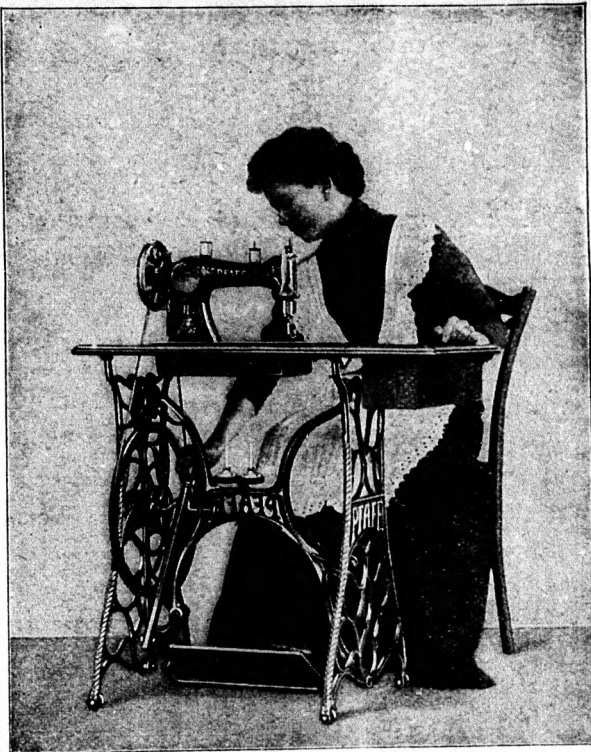
Pfaff 31. oszt. „H” központi orsós varrógép családi használatra, varrónők, fehérneműgyárak stb. részére.
