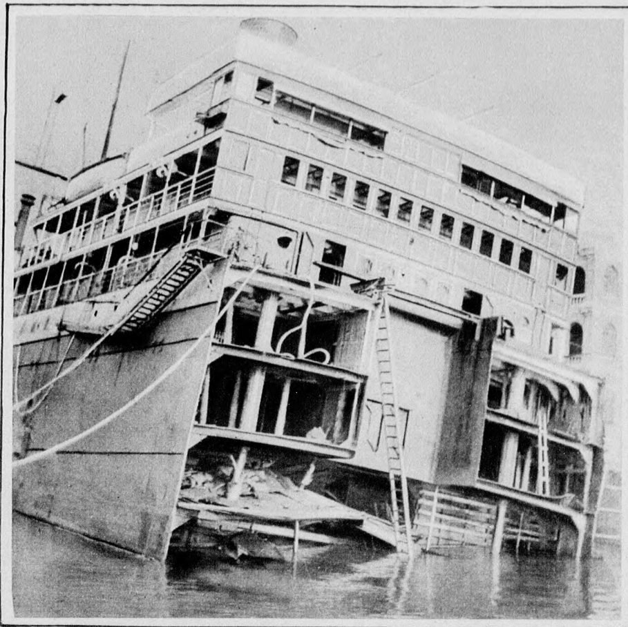
Egy zátonyra futott hajót csak úgy lehetett megmenteni, hogy az egész hajót kettévágták és a vízfölötti részt bevontatták a kikötőbe. A vízalatti részt felrobbantották
