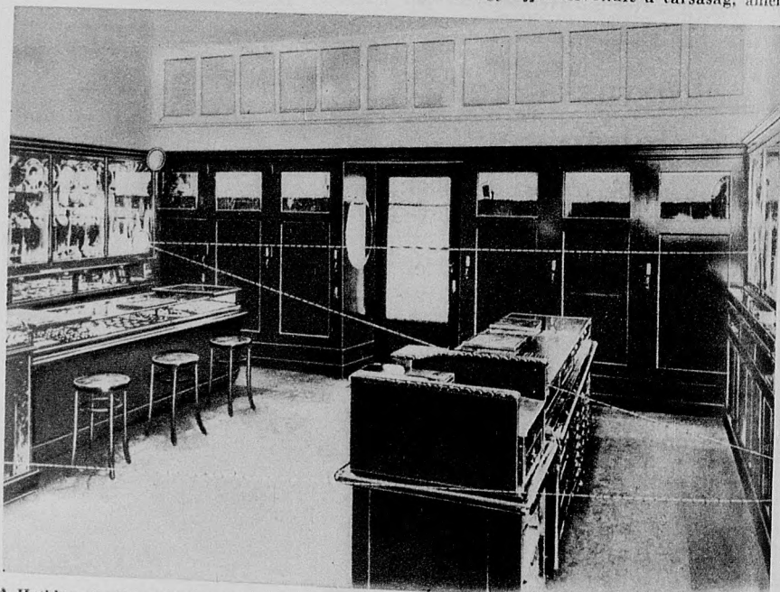
A Holkins cég ékszerének védelme. Az üzletben négy különböző sarokban négy fotocellát képesnek be zárás után. A fotocellákra vetített láthatatlan ultravörös fény megszakadása esetén azonnal vészcsöngő szólal meg a Scotland Yardon. (Itt bemutatott képünkön a felhár szakadozott vonalak jelzik a láthatatlan, vörösön túll fény útját.)
