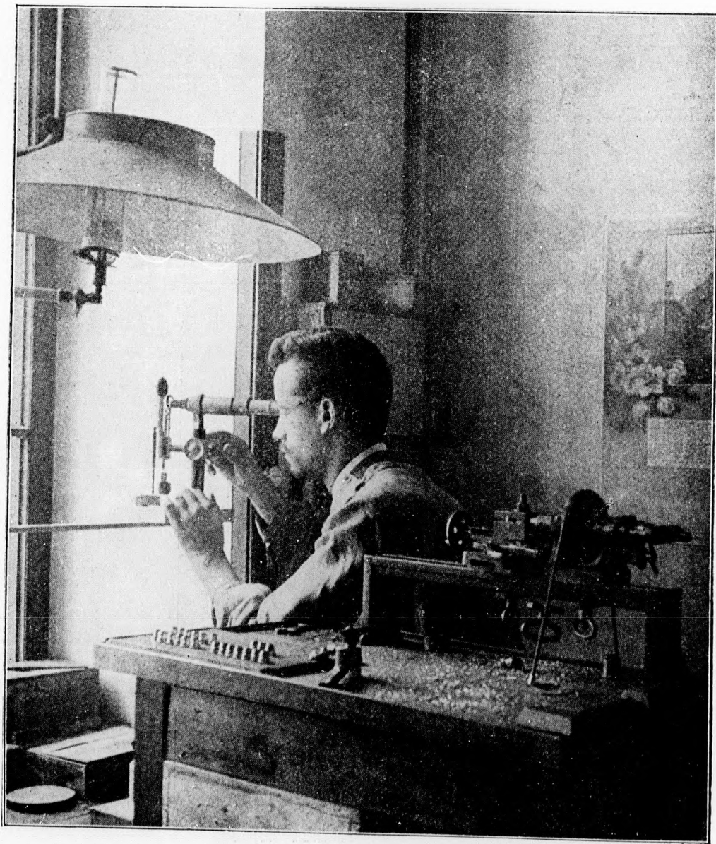
15. rajz. A lensék foglalása. A tárgylencse lencséinek egymástól való távolságának meghatározása.
