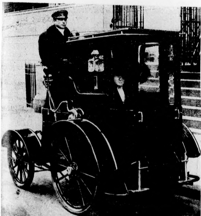
Automobil egy személyre. Egy amerikai milliomas a felesége részére együléses autót építtetett aluminiumból. A gépkocsi gyönyörű kiállítású és 40 kilométer sebességgel tud haladni.
