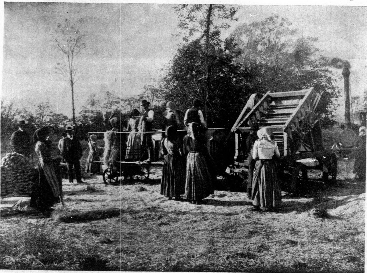
17. ábra. Kettős rendszerű olasz kenderkimunkáló gép a lokomobillal ellentétes oldalról nézve. Balról a tiloló gép, jobbról a törőgép.
