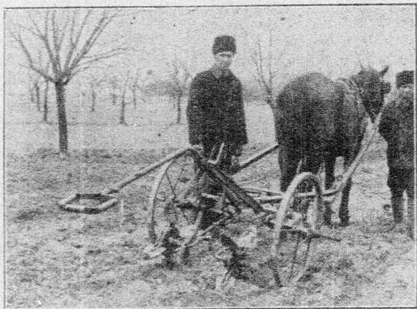
48. sz. kép. Sack-féle gép lyukvágó csillaggal.
