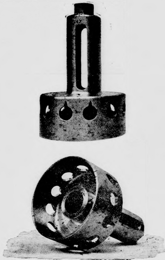
4. és 5. ábra. A Collmann-féle uj vezérmű kataraktus-dugattyújának képei.
