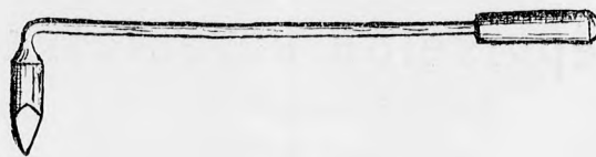
Abb. 7. LötKolben nach Theophilus, um 1100. (Rekonstruiert vom Verfasser.)
